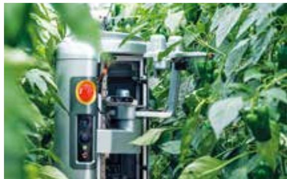
ピーマン自動収穫ロボット「L」
