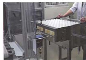
【BOD自動分析装置】
