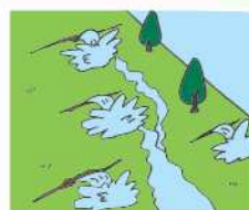
斜面から水が噴き出す。
